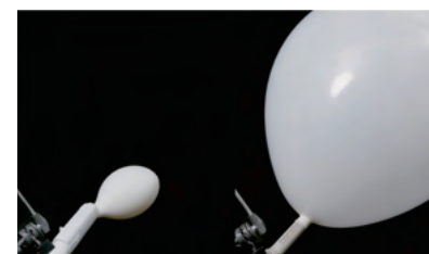
風圧実験：風船が一瞬で膨らむ高風圧
