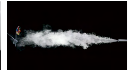
風速実験: 2m先の風車を回す高風速
