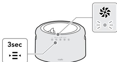
3. 電源ボタンを押すと、インジケーターが消灯し、内部乾燥機能が終了します。
