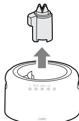
2. 運転停止の状態にあることを確認の上、モードボタン・を3秒以上長押しすると急速インジケーターが点滅し、内部乾燥機能が開始します。
