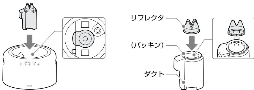
加湿量の低下や、床濡れ、水漏れの原因になりますので、ダクト(パッキン)・リフレクタは必ず取り付けてください。
