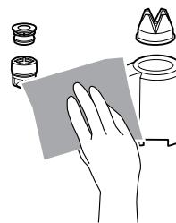
12. 本体底部のフィルターカバーとエアフィルターを取り出し水洗いします。
