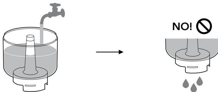
! フィルターカートリッジは給水制御も行うため、取り付けずに使用すると水漏れが発生します。フィルターカートリッジは必ず取り付けて、水漏れがないことを事前に確認してください。
