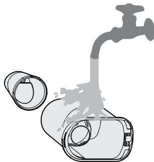
8. 残ったタンクの水を捨てタンクキャップを取りはずし、水道水でタンク内と、タンクの裏側をスポンジなどで水洗いします。
