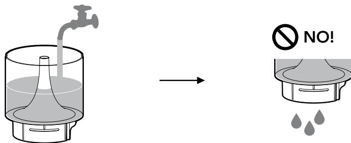
! タンクキャップは給水制御も行うため、取り付けずに使用すると水漏れが発生します。タンクキャップは必ず取り付けて、水漏れがないことを事前に確認してください。
