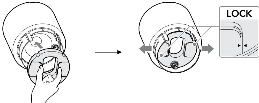
4. タンクに水を入れた後、しばらく時間を置き、タンクの裏から水漏れがないことを確認します。水漏れが発生している場合は、水を捨て、タンクキャップを正しく取り付け直してください。
