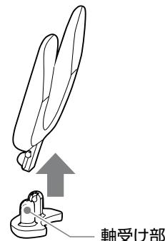
3. 取り付けの際はフロートの先端を上向きにして軸受け部に差し込みます。
